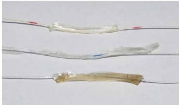
Figura 1a. Immagine dei tre sensori prototipali: in alto “Agar+Chitosan”, al centro “Agar thin”, in basso “Agar thick”.
