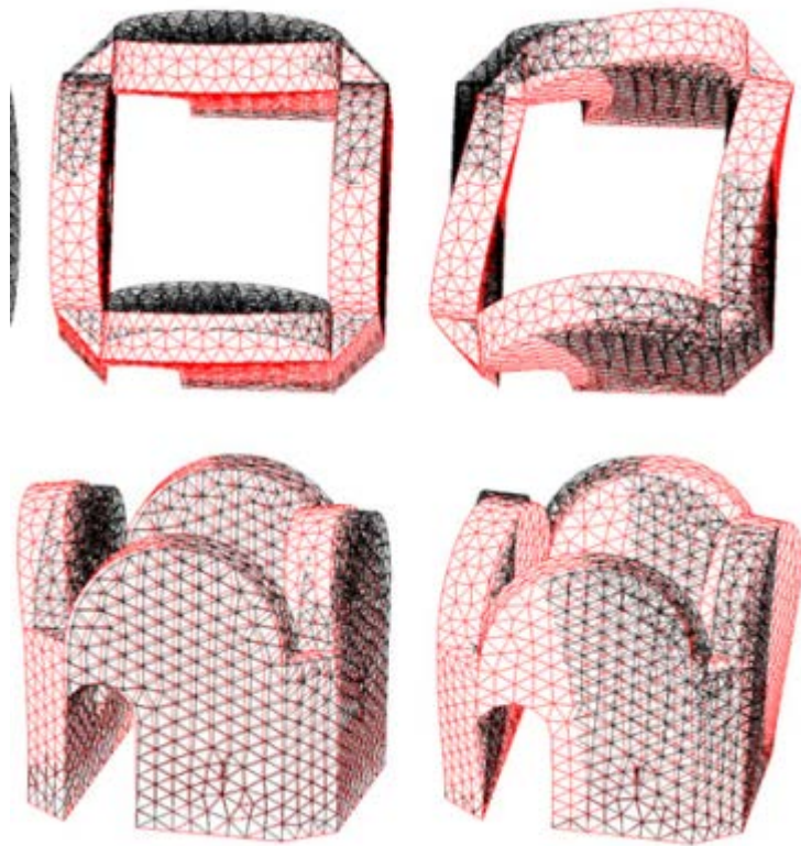
Figura 7. Mesh ottenuta da modello 3D SfM della torre L3 (Mura Aureliane) per calcolo agli elementi finiti delle deformate modali
