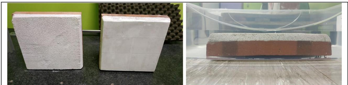
Fig. 4: Provini con muratura a secco (a); WT2 nella vaschetta durante il processo di imbibizione (b).
