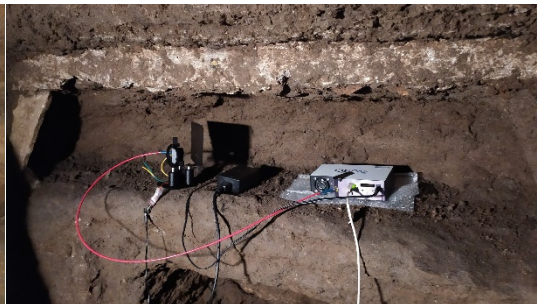
Figura 4: misure di fluorescenza in situ .
