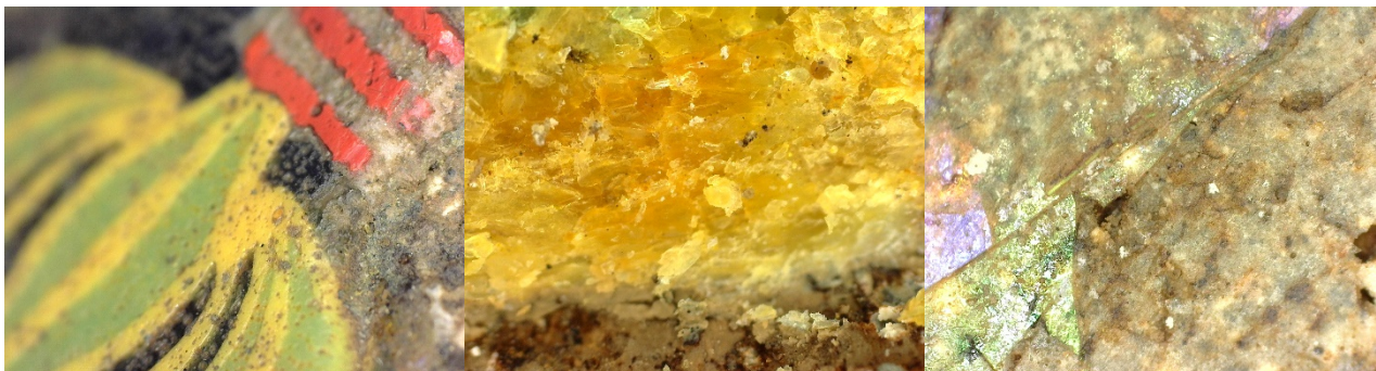
Figura 5: particolare della sezione della tessera (sinistra), cristalli relativi alla parte superiore del deposito (centro), particolare di un frammento del vaso ancora inserito nella malta (destra).
