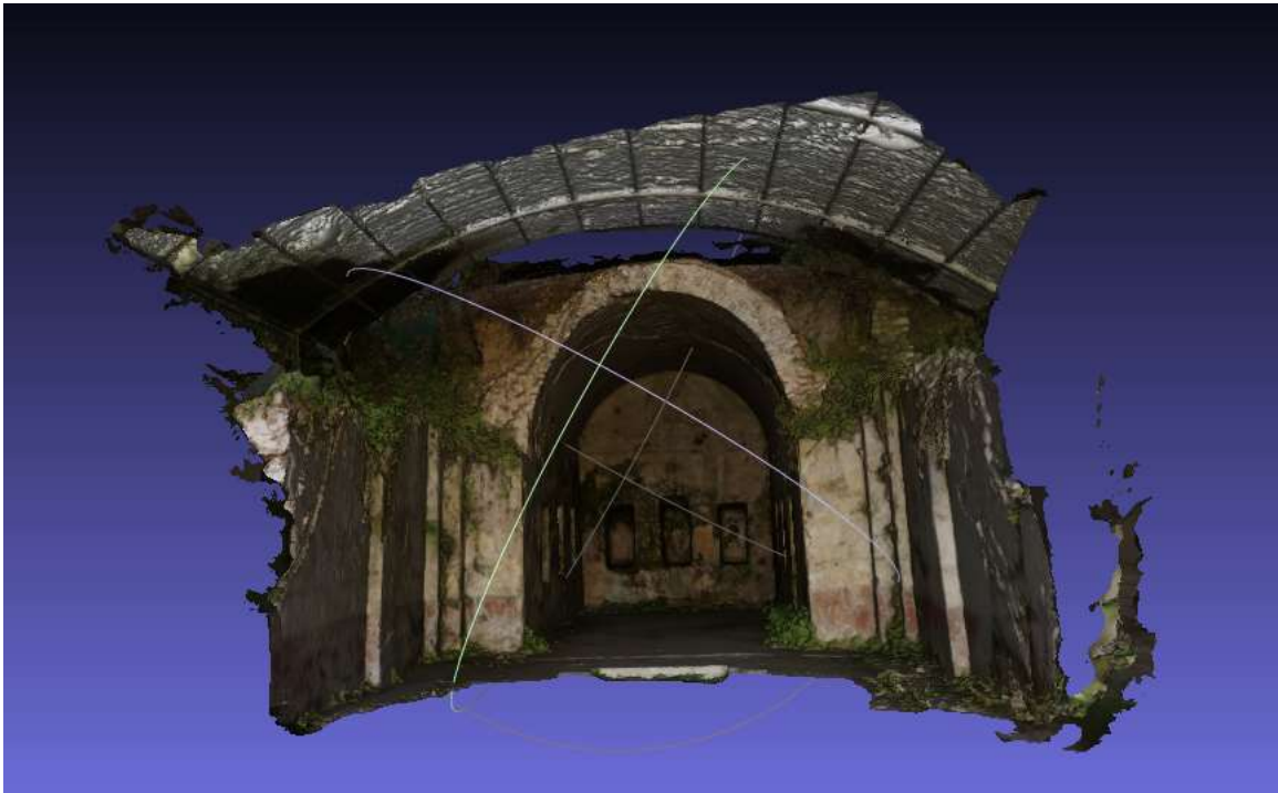
Figura 1: ninfeo Ponari, ricostruzione 3D ottenuta con elaborazione Structure From Motion del rilievo fotogrammetrico.
