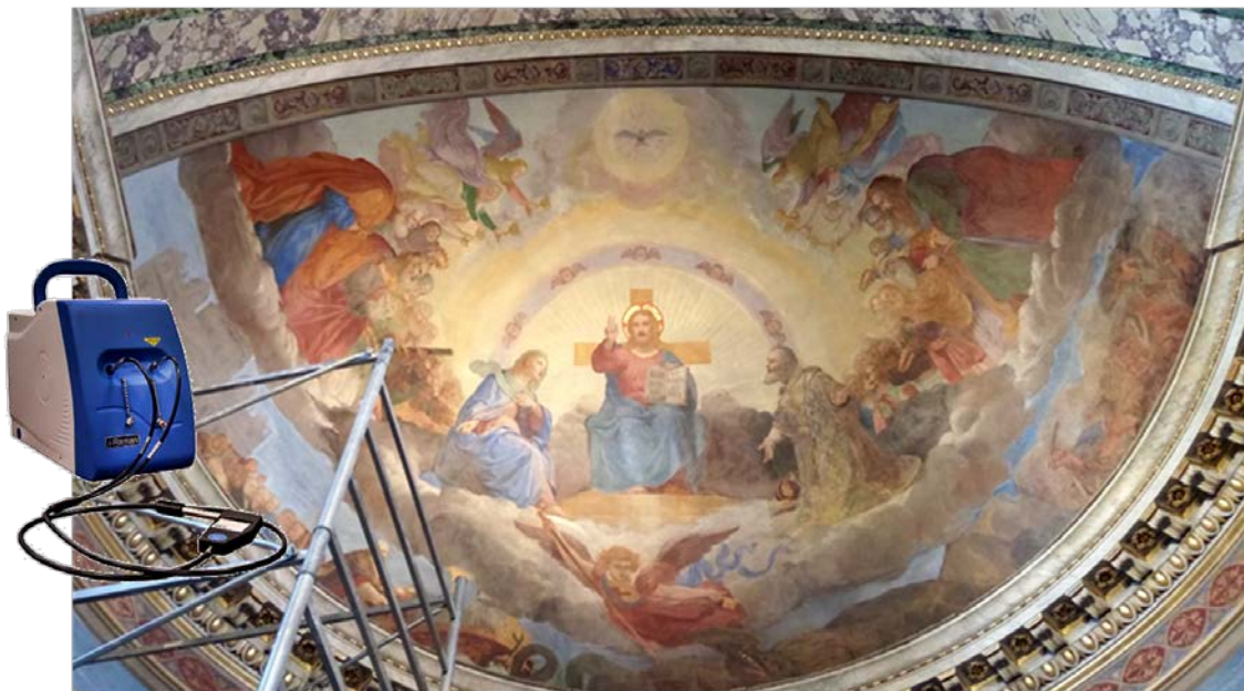
Figura1. Spettrometro Raman portatile con sonda utilizzato per misure "in-situ" sull'affresco absidale della Basilica S. Nicola in Carcere
