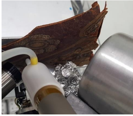
Figura 9: set-up geometrico utilizzato per la misuradi Ion Beam Analysis –PIXE con protoni da 3 MeV.
