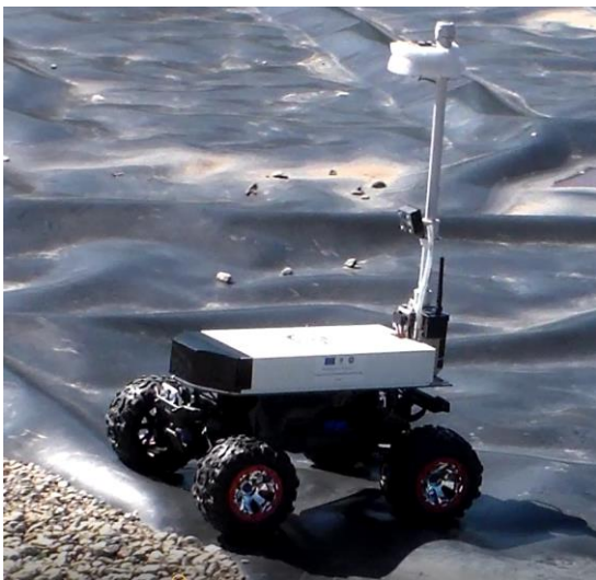
Figura 2. (Sinistra) Sistema veicolare terrestre radio-guidato, alloggiante sensori per composti chimici aeriformi, gas e particolato; (destra) stand espositivo di IIA-CNR con veicolo e sistemi visivi di rilevazione e registrazione dati da remoto.
