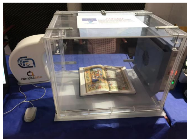
Figura 1. (Sinistra) Stand espositivo con alcuni dei dispositivi sensoristici realizzati presso IIA-CNR; (destra) dispositivo multisensoriale per il monitoraggio di composti chimici volatili in microambienti (es. teche per manufatti artistici)
