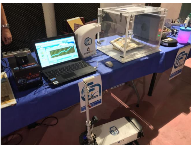
Figura 1. (Sinistra) Stand espositivo con alcuni dei dispositivi sensoristici realizzati presso IIA-CNR; (destra) dispositivo multisensoriale per il monitoraggio di composti chimici volatili in microambienti (es. teche per manufatti artistici)
