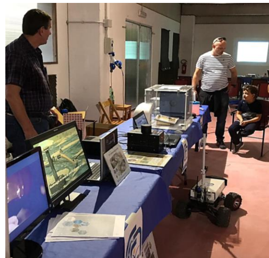
Figura 2. (Sinistra) Sistema veicolare terrestre radio-guidato, alloggiante sensori per composti chimici aeriformi, gas e particolato; (destra) stand espositivo di IIA-CNR con veicolo e sistemi visivi di rilevazione e registrazione dati da remoto.
