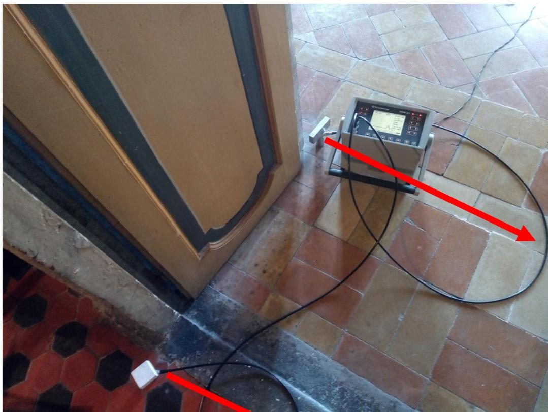
Figura 16 Posizione delle sonde UT
