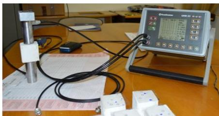
**Figura 13 - Strumento Krautkramer USM 23 LF a bassa frequenza**
