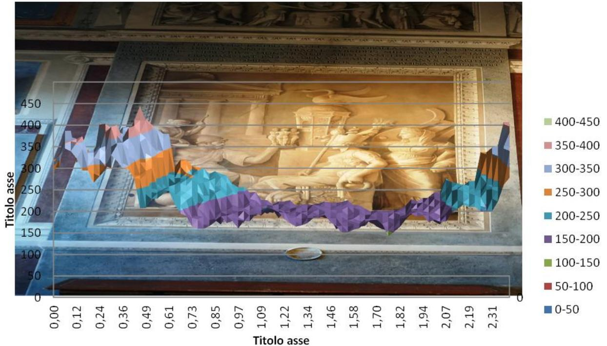
Figura 11 Profili delle velocità ultrasonore all'interno della muratura
