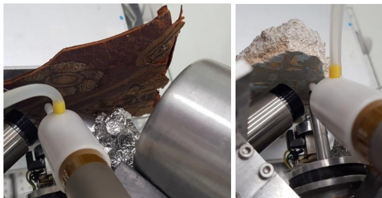
Figura 3: set-up geometrico utilizzato per la misura di Ion Beam Analysis –PIXE con protoni da 3 MeV.
