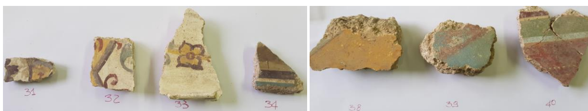
Figura 2: fotografia dei frammenti di affresco romano proveniente dalla Villa della Piscina (Centocelle, RM) che sono stati sottoposti ad indagine Ion Beam Analysis –PIXE ed XRF.
