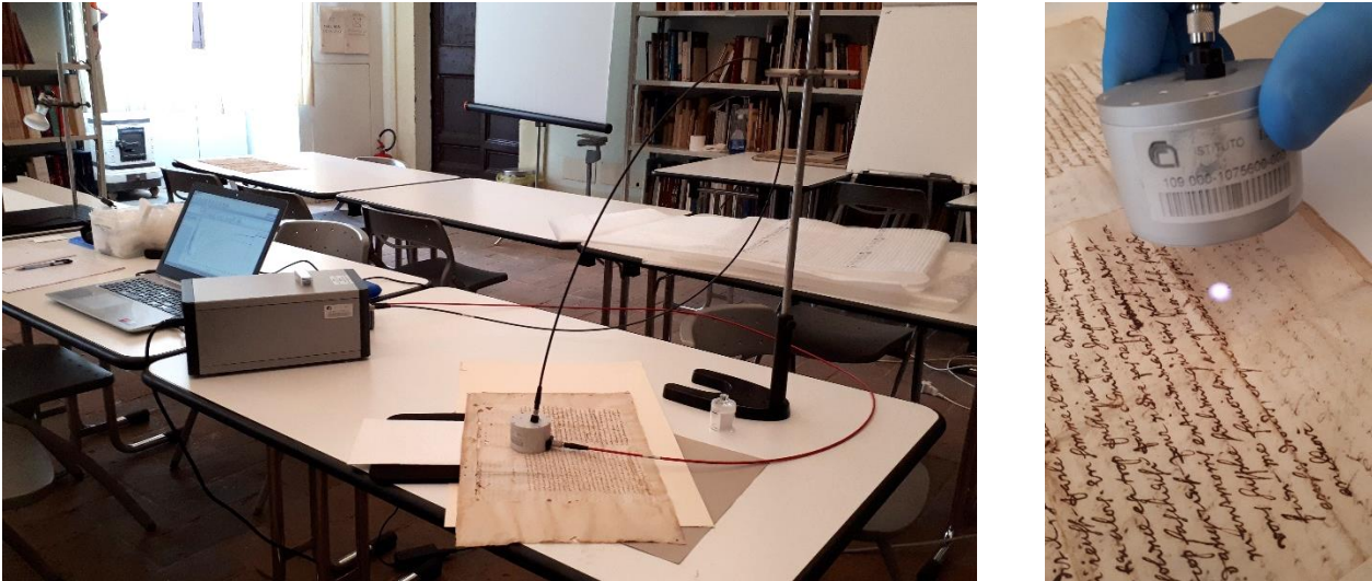
Figura 3 Il sistema FORS UV-Vis durante le misurazioni sulle lettere di San Francesco di Sales a Palazzo Chigi di Ariccia (a sinistra). Particolare della sfera integratrice prima del posizionamento a contatto con la superficie cartacea (a destra).
