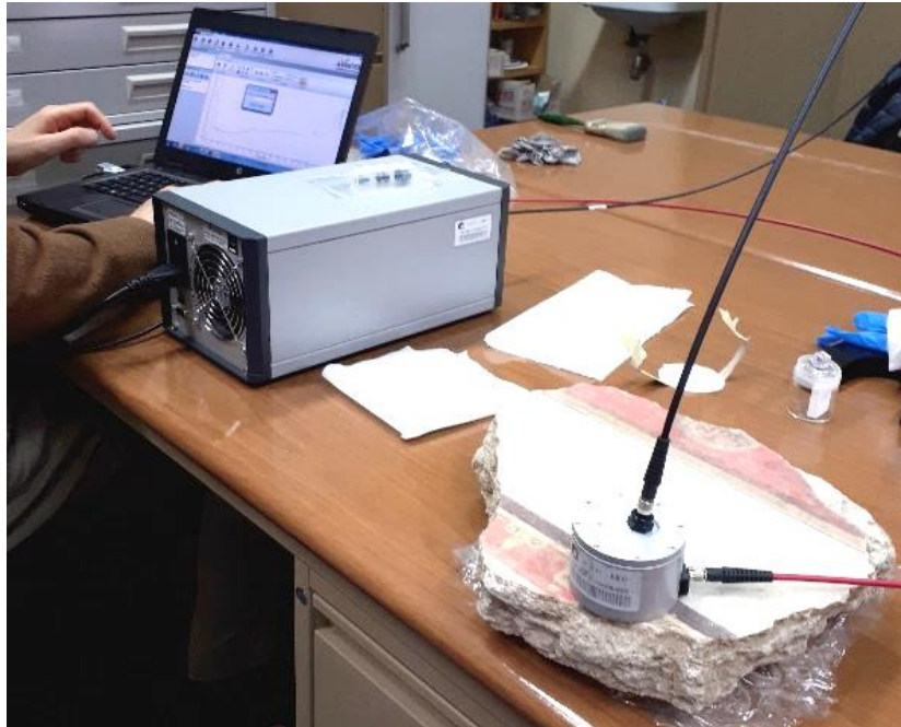
Figura 1 Il sistema per la spettroscopia ultravioletto-visibile di riflettanza in grado di analizzare luce riflessa dai campioni per permettere l'identificazione dei pigmenti. E' visibile in primo piano la sfera integratrice ottica che permette misure di riflettanza assolute
