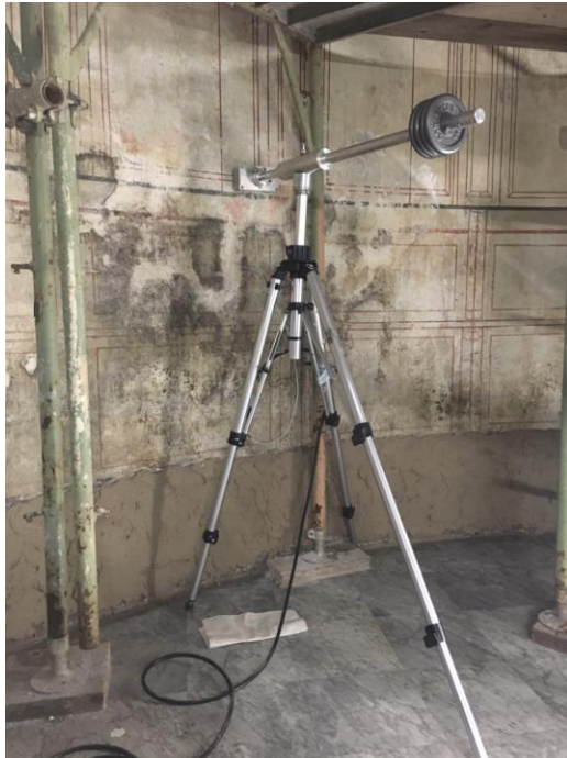
Figura 1. Risonanza Magnetica portatile durante le indagini alla Chiesa di San Nicola in Carcere
