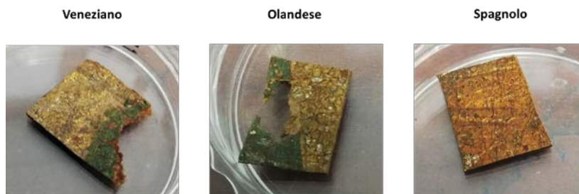
Figura 4: fotografie del lato "top" dei tre campioni analizzati, prima del rivestimento con cromo
