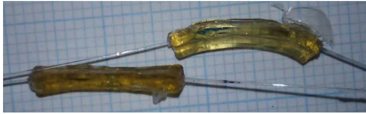
Sensori RH in fibra ottica realizzati con coating in Agarose.
