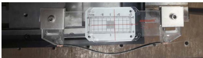
Fessurimetro in fibra ottica in fase di calibrazione in laboratorio ENEA.
