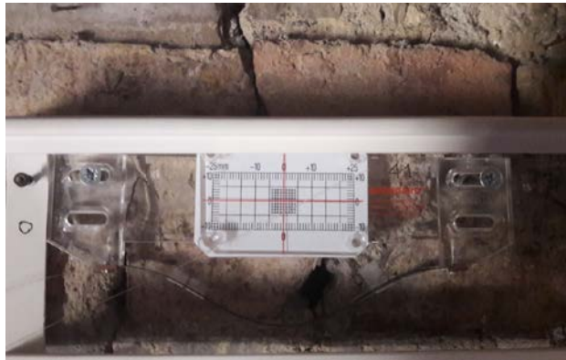
Attività di installazione (immagine sx); sensore in posizione, box protettivo aperto (immagine dx).
